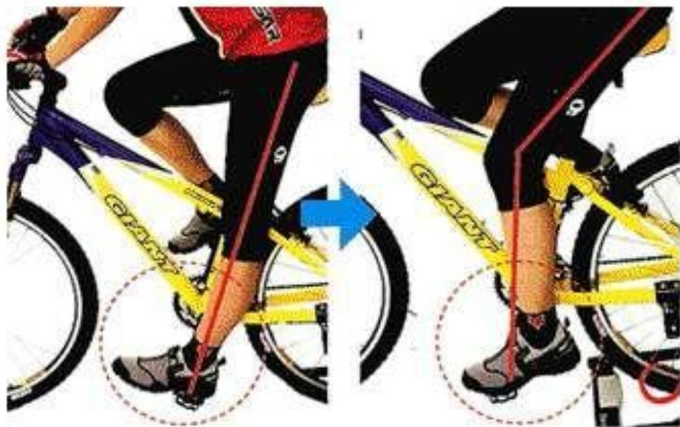
簡易高度測量法第1步，腳跟放在踏板上，膝蓋打直(圖B1)
